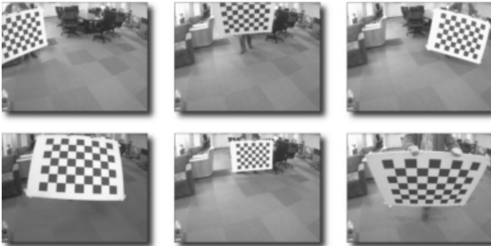
FIGURE 3.13 – Objet utilisé lors de la calibration des caméras en configuration stéréoscopique.
