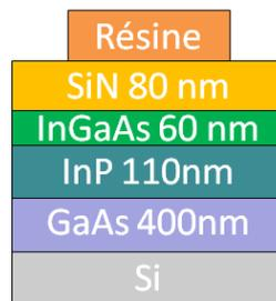
**Figure II.3 – Schéma de l’empilement des matériaux présents lors de l’utilisation d’une couche d’InGaAs épitaxiée directement sur silicium et structurée avec un masque dur SiN et une lithographie optique 193 nm**
