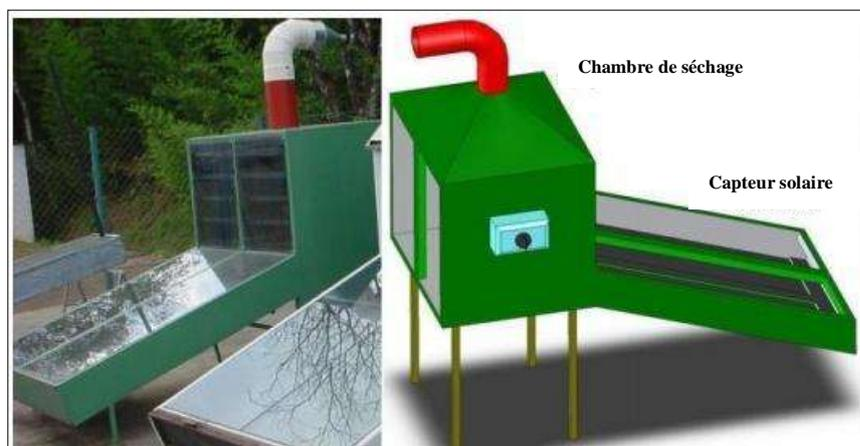
**Figure I. 26 :** Séchoir solaire hybride.
