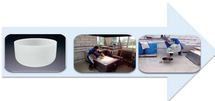
Figure 84 Procédés de fabrication des échantillons de verre borosilicaté: creuset à quartz, technique de trempe à l'état fondu.
