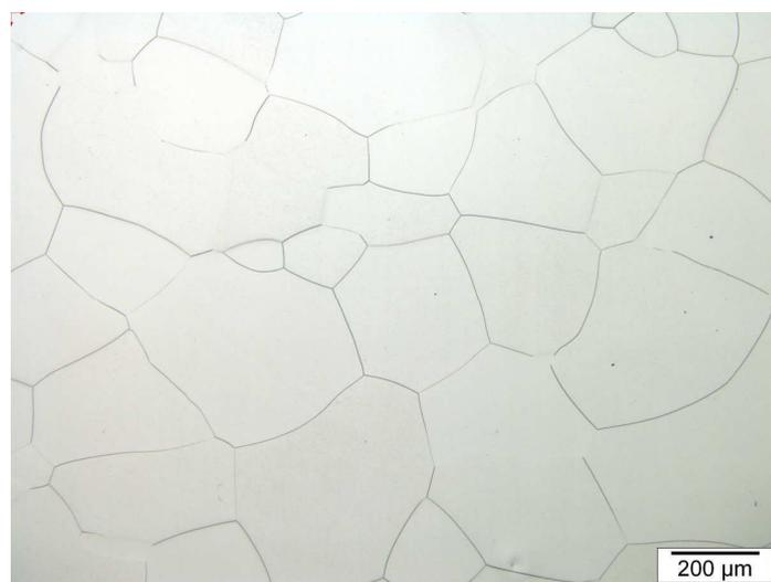
**Figure IV. 4** Microstructure du fer pur
