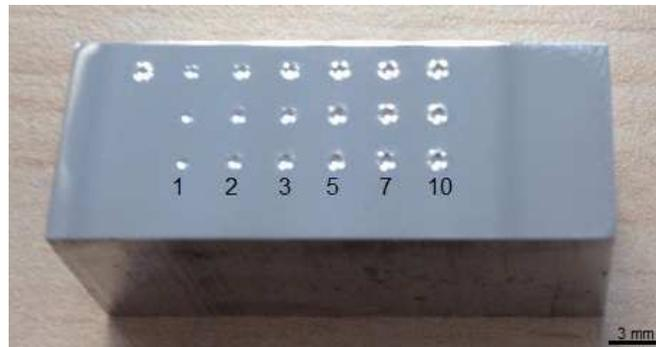
**Figure II. 5 Photographie des impacts réalisés sur un échantillon d'aluminium**
