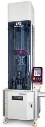
*Figure 2-16 Dispositif de puit de chute*
