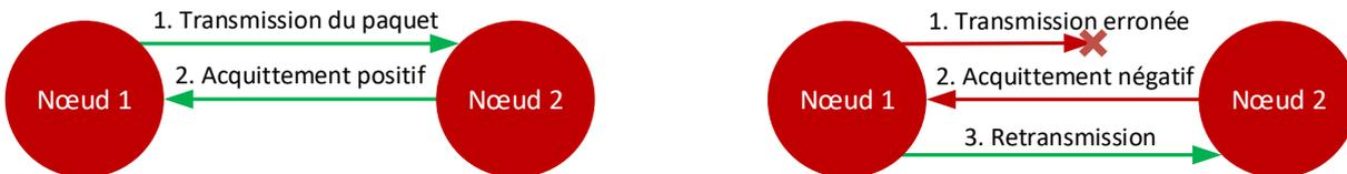
FIGURE 4.2 – Mécanisme de retransmission
