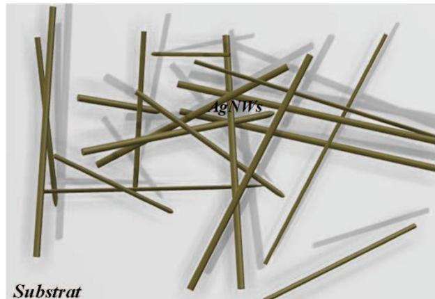
*Figure II. 1 : Représentation des AgNWs déposés de façon aléatoire sur un substrat*
