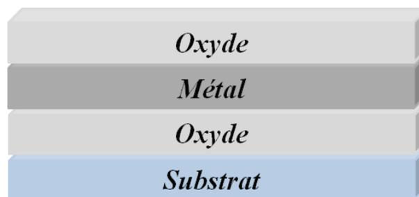
**Figure I. 19** : Représentation de la structure OMO.
