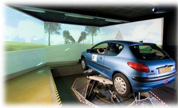
FIGURE 5.1 – Le simulateur de conduite SHERPA-LAMIH
