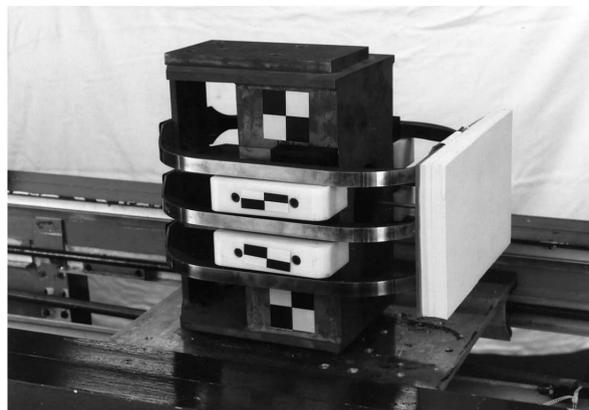
FIGURE 1.21: Photographie de la structure 3-RCS pour simuler le comportement thoracique lors d'impacts balistiques non pénétrants [44].
