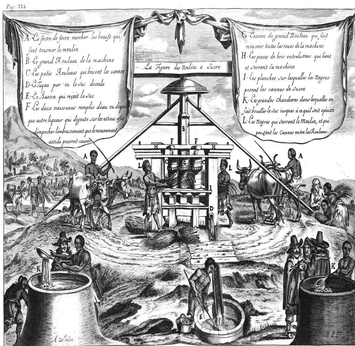
Figure 25 (retranscription de la légende) : titre= La figure des moulins à sucre ; A= La façon de faire marcher les bœufs qui font tourner le moulin ; B= Le grand rouleau de la machine ; C= Les petits rouleaux qui brisent les cannes ; D= Le tuyau par où le suc découle ; E= Le bassin qui reçoit le suc ; F= Les deux vaisseaux remplis d'eau ou de quelque autre liqueur qui dégoûte sur les essieux, afin d'empêcher l'embrasement que le mouvement assidu pourroit causer ; G= L'essieu du grand rouleau qui fait mouvoir toutes les roues de la machine ; H= Les pièces de bois entrelassées qui lient et serrent la machine ; I= Les planches, sur lesquelles les Nègres posent les cannes de sucre ; K= Les grandes chaudières dans lesquelles on fait bouillir le suc jusques à ce qu'il soit épaissi ; L= Les Nègres qui servent le moulin, et qui poussent les cannes entre les rouleaux.
