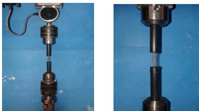
Figure 71 : Dispositif de traction pour la caractérisation mécanique des mèches de fibres de lin.
