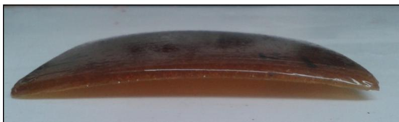
Figure 93 : Flexion du polymère massif due à la relaxation des contraintes résiduelles de mise en œuvre après 100 jours d'immersion dans l'eau distillée portée à 70°C.
