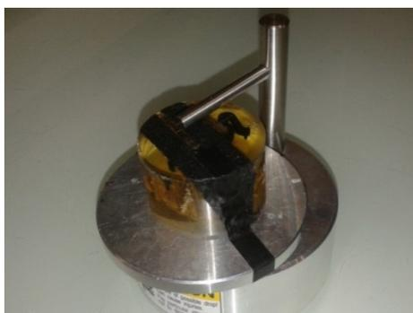
Figure 70 : Préparation de l'échantillon pour l'analyser par la mise en place d'un scotch carbone destiné à minimiser les artéfacts.
