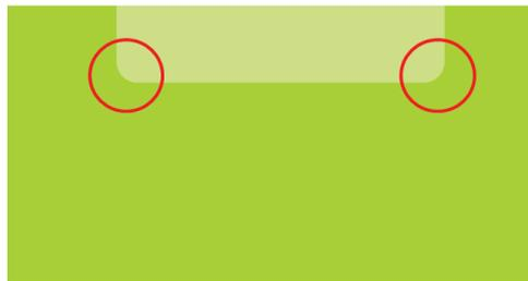
**Figure 1.25** : *Vue en coupe d'une structure 2D d'une jonction p-n, illustrant les zones anguleuses favorisant la concentration du champ électrique, et au claquage prématuré du composant*
