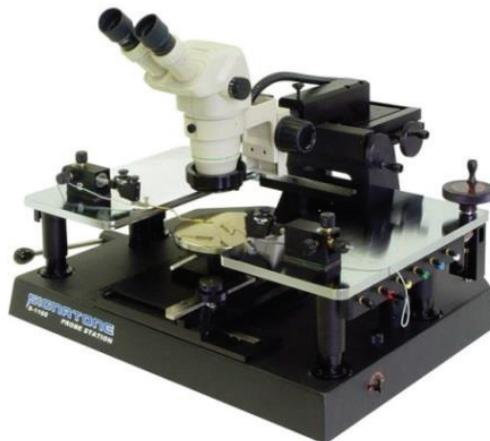
***Figure a : Photographie du banc de caractérisation électrique utilisé :
