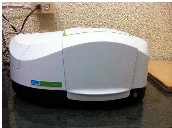
Figura 14. Espectrofotómetro de infrarrojo marca Perkin Elmer, modelo Spectrum Two
