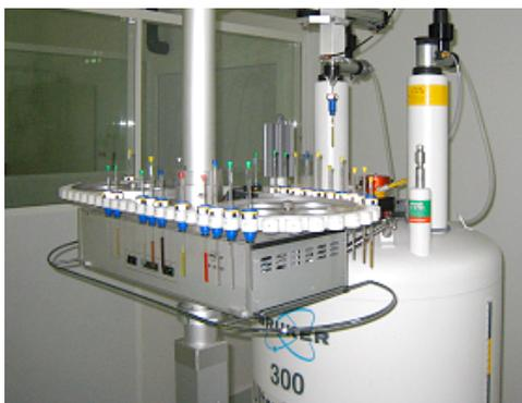
Figura 15. Equipo de RMN Bruker-Avance de 300 MHz
