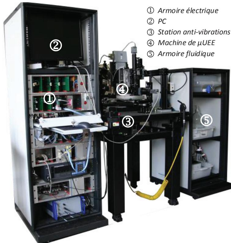
**Figure 49** – Vue de la machine de 2<sup>ème</sup> génération avec les postes gravure et usinage sur la table anti vibration et les armoires électronique (à gauche) et fluidique (à droite).
