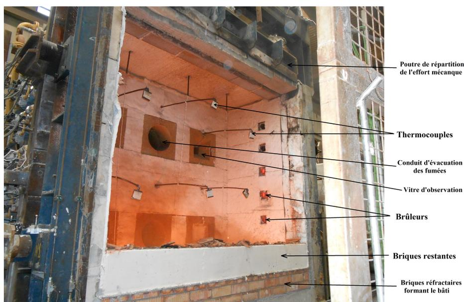
FIGURE 2.17 – Four après la rupture du mur
