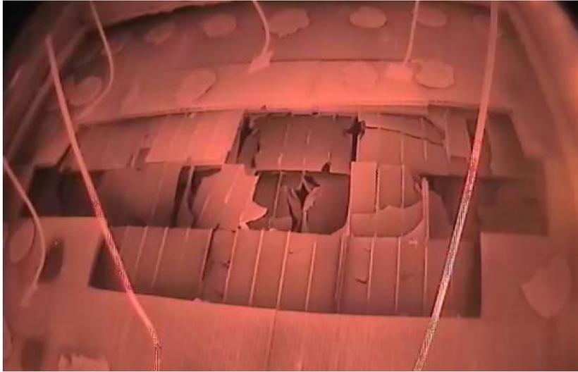
FIGURE 2.14 – Etat d'écaillage du mur costo à 40 min d'essai
