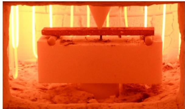
FIGURE 5.12 – Essais de flexion 3 points in-situ
