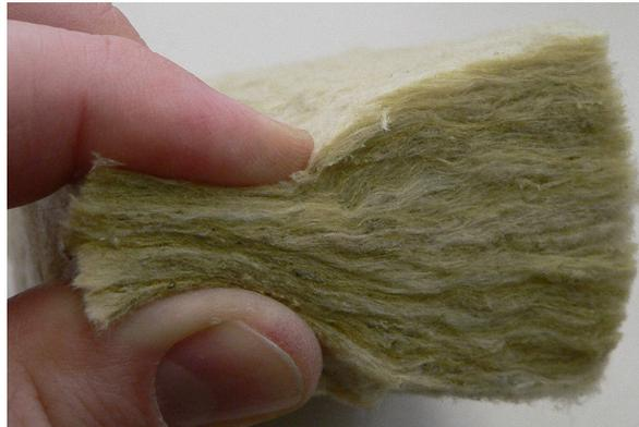
FIGURE 2.5 – La laine de roche utilisée sur les bords latéraux
