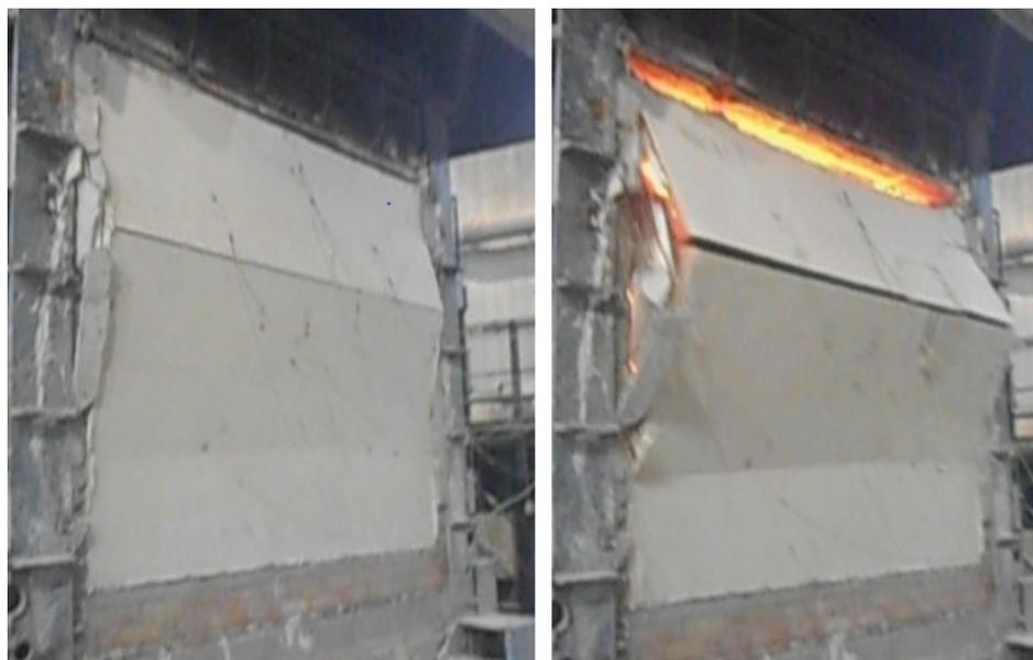
FIGURE 2.16 – Mécanisme de ruine du mur Costo
