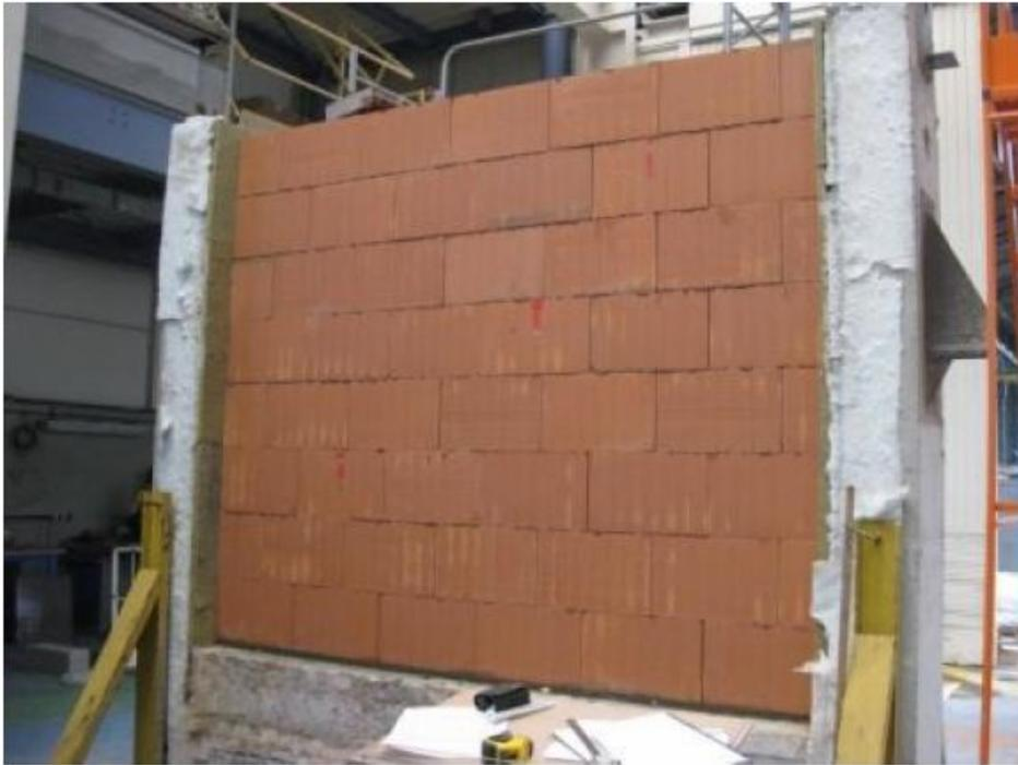
FIGURE 2.4 – Vue du mur à la fin de la pose des briques
