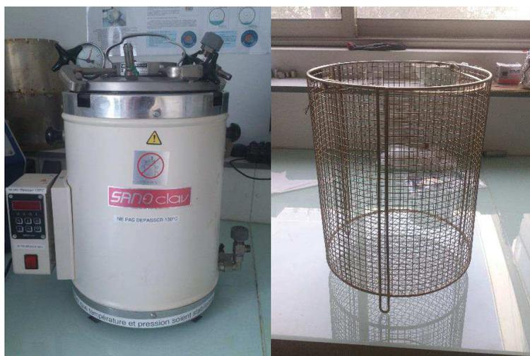
**Figure II. 6** : Autoclave (à gauche) et cage support (à droite) utilisés pour le vieillissement.
