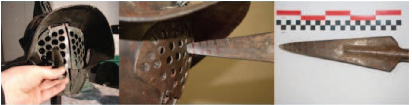
Image 25 : Pénétration des armes d'hast dans les casques : à gauche une pointe de lance et un casque du ludus de la caserne de Pompéi, conservé au musée de Naples. Au centre et à droite, le test effectué avec des copies d'artefact.
