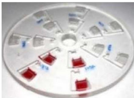
Figure V-1 : Lab-on-CD dans lequel les opérations fluidiques sont intégrées [4]
