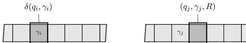
**FIGURE 2.11** – Représentation d'un ruban de lecture/écriture d'une Machine de Turing qui est dans un état de départ  $q_i$  et qui lit le symbole  $\gamma_i$  pour passer dans un état d'arrivée  $q_j$ , en remplaçant  $\gamma_i$  par  $\gamma_j$  et en déplaçant la tête de lecture vers la droite
