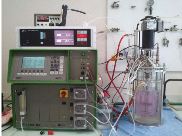
Figure II-4 : Réacteur de 4 L pour la coculture de bactéries nitrifiantes en cellules libres.
