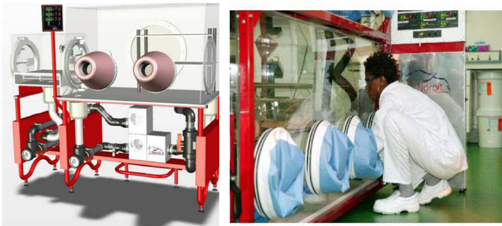
Figure I-21: Schéma du réacteur du compartiment C5 (gauche) et photo lors d'une manipulation (droite).
