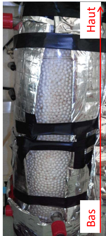
Figure IV-12: Photo du lit fixe après la mise en place du mode continu à 55 jours.
