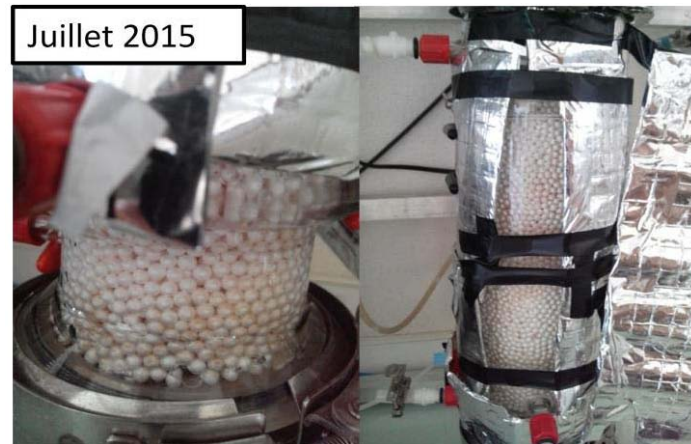
Figure IV-19: Développement de la biomasse en bas de réacteur (gauche) et dans la partie centrale (droite) à la fin de la phase P19. La biomasse crée une zone marron, elle est peut perceptible sur le lit fixe.
