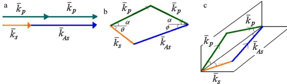
**Figure 1.11** – Différentes adaptations de phases les plus employées pour le CARS [44] : (a) CARS colinéaire ; (b) box-CARS ; (c) folded box-CARS (« box-CARS plié »). Chaque vecteur  $k_i$  représente le vecteur d'onde associé à chaque onde et dont la norme est définie par  $\|k_i\| = \omega_i/c$  (où  $c$  est la célérité de la lumière).
