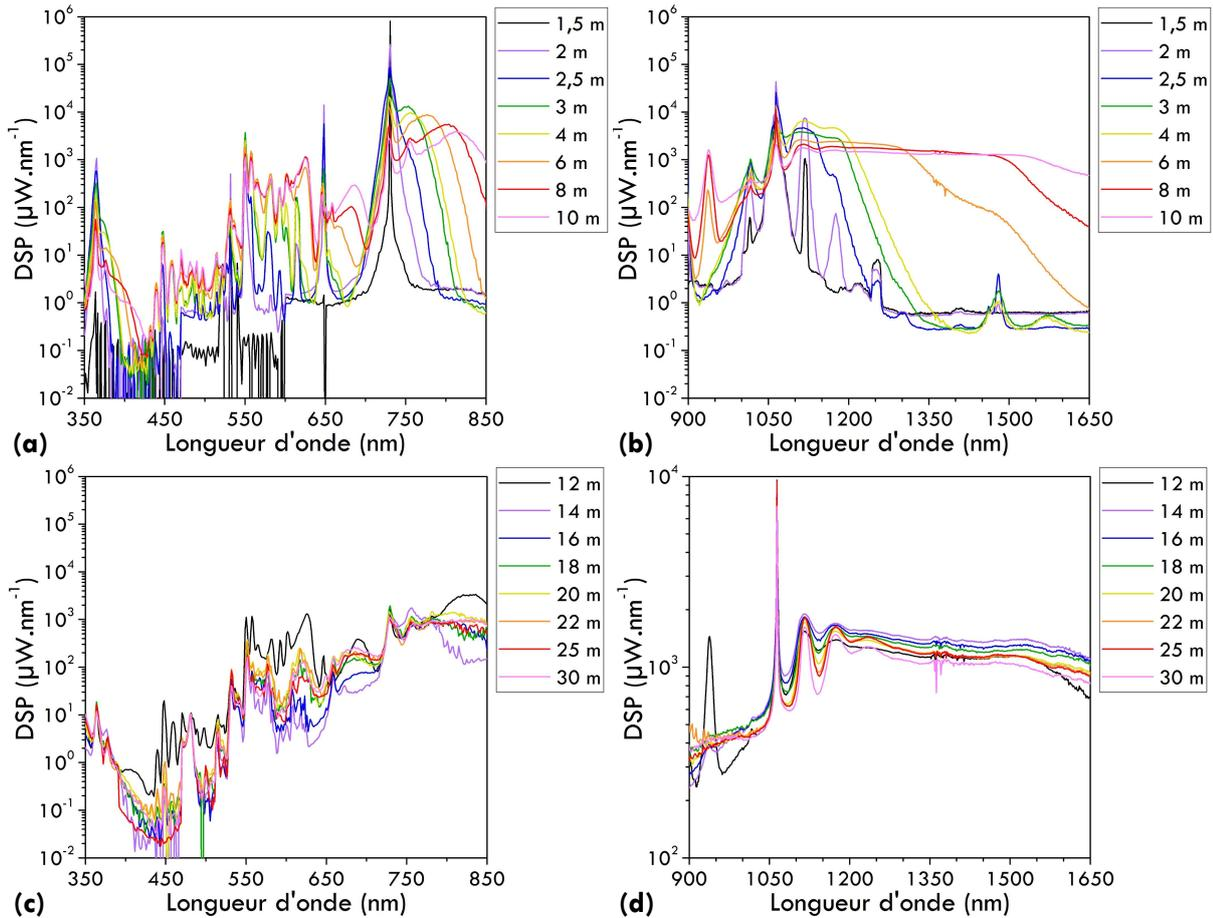
**Figure 4.15** – Spectres mesurés à la sortie de la fibre MMF-Ge pompée avec des impulsions de 60 kW crête en fonction de la longueur du tronçon : entre 1,5 m et 10 m sur la bande 350 nm – 850 nm (a) et la bande 900 nm – 1650 nm (b) ; entre 12 m et 30 m sur la bande 350 nm – 850 nm (c) et la bande 900 nm – 165 nm (d).
