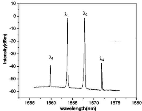
**Figure 2.28** – Exemple de mélange à quatre ondes : deux ondes à  $\lambda_1 = 1563,84$  nm et à  $\lambda_2 = 1567,83$  nm engendrent la création de deux ondes à  $\lambda_3 = 1559,91$  nm et  $\lambda_4 = 1571,82$  nm [139].
