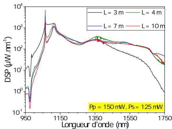
**Figure 3.15** – Spectres mesurés en sortie de tronçons de fibre FMAS-Yb de longueurs variables, dans lesquelles sont injectés un signal à 1064 nm ( $P_s = 125 \text{ mW}$ ) et une pompe à 980 nm ( $P_p = 150 \text{ mW}$ ).
