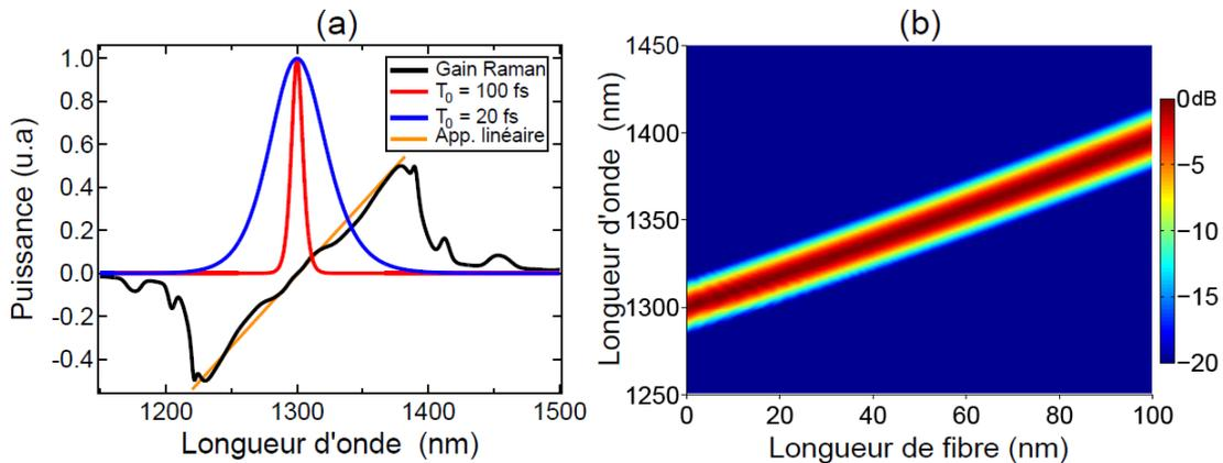
**Figure 2.32** – (a) Illustration du recouvrement spectral entre la courbe de gain Raman en noir et le spectre de deux impulsions de durée 100 fs (rouge) et 20 fs (bleue). Une approximation linéaire du gain Raman est proposée en orange ; (b) Autodécalage fréquentiel d'un soliton par effet Raman (durée d'impulsion : 60 fs) [150].
