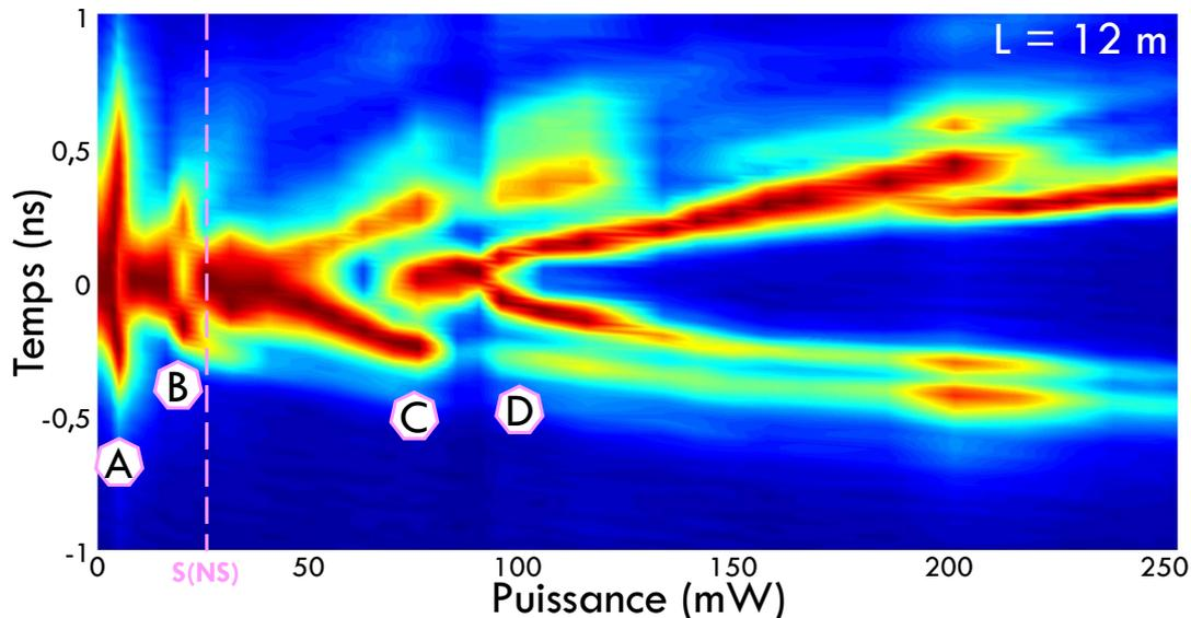
**Figure 4.19** – Évolution spectrotemporelle du faisceau à 1064 nm en sortie d'un tronçon de 12 m de fibre MMF-Ge en fonction de la puissance de signal en entrée. S(NS) : Puissance seuil du nettoyage spatial. Les repères A, B, C et D représentent respectivement les puissances 3 mW, 21 mW, 76 mW et 100 mW.
