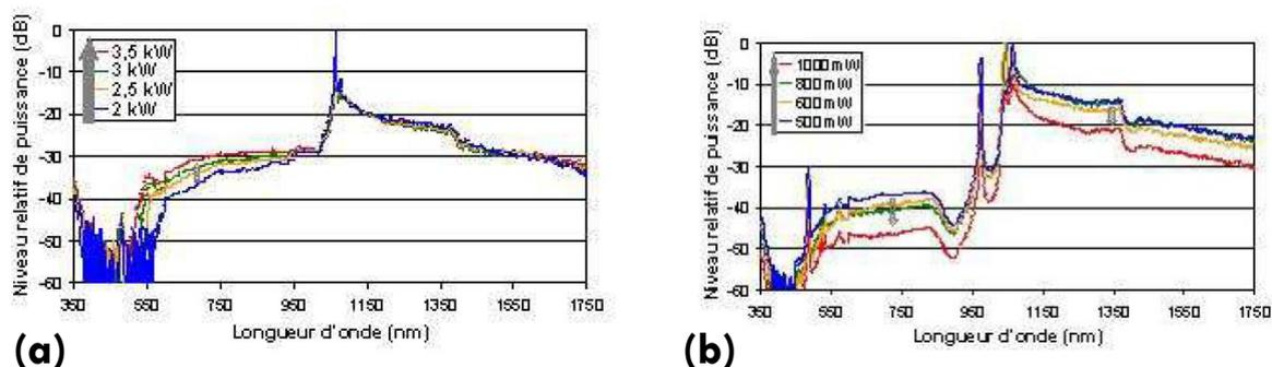
**Figure 3.4** – Principaux résultats de la Référence [199] : (a) spectres en sortie de 3 m de fibre microstructurée passive en fonction de la puissance de signal (1064 nm) d'entrée; (b) spectres en sortie de 3 m de fibre microstructurée active en fonction de la puissance de pompe (975 nm) en entrée.
