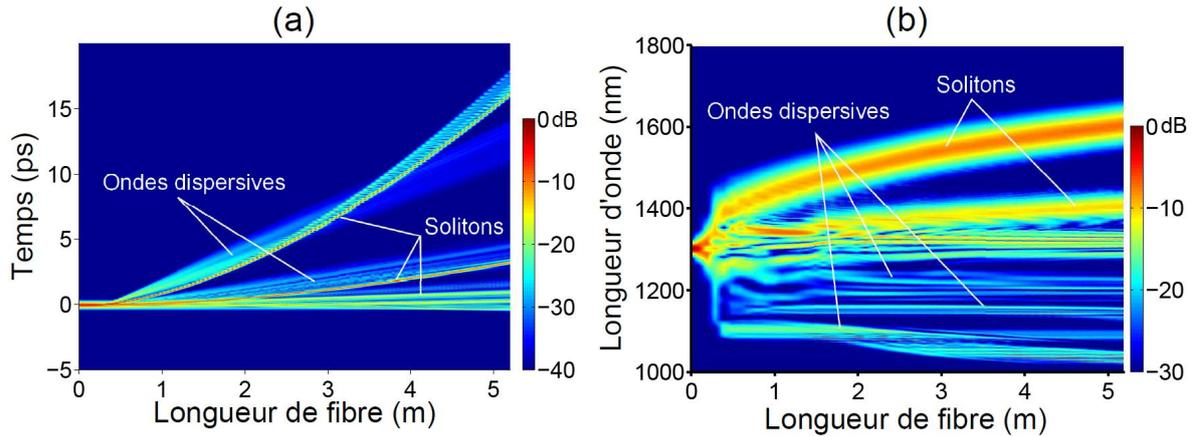
**Figure 2.34** – Résultat de simulations (a) temporel et (b) spectral de la fission d'un soliton d'ordre  $N = 6$  dont les solitons résultants subissent un autodécalage fréquentiel et génèrent des ondes dispersives [150].
