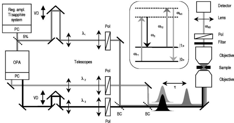
**Figure 1.14** – Schéma du dispositif de microscopie CARS femtoseconde résolu en temps [52]. Insert : diagramme d'énergie du processus de mélange à quatre ondes dans le cas non dégénéré. PC : système de compression d'impulsion ; VD : ligne à retard variable ; Pol : polariseur ; BC : miroir dichroïque.
