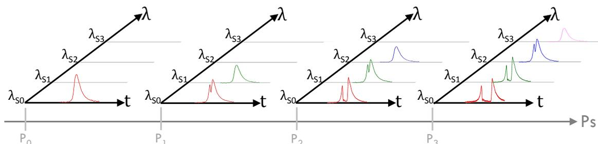
**Figure 4.11** – Illustration des conversions Raman en cascade conduisant à la déplétion de la pompe principale ( $\lambda_{S_0}$ ) et des pompes secondaires (pics Raman aux longueurs d'onde  $\lambda_{S_n}$ ) lors de l'augmentation de la puissance de signal  $P_S$  injecté dans la fibre. Le déclenchement du transfert d'énergie d'une longueur d'onde  $\lambda_{S_{n-1}}$  à une longueur d'onde  $\lambda_{S_n}$  est associé à une puissance moyenne de signal dans la fibre  $P_n$ .
