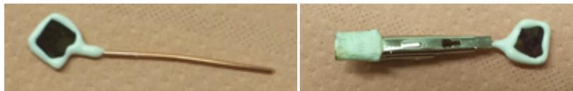
Figure IV-28 : photo d'une électrode de  $p$ -Si dont le contact ohmique est assuré par un eutectique Ga-In et une résine époxy à l'argent (gauche) seule et (droite) tenue par une pince.
