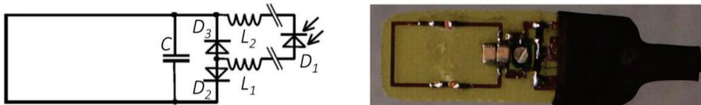
Figure 1.14. Représentation schématique (en haut) et photographie (en bas) du circuit de découplage proposé par Korn *et al.* [61]. Lorsque la photodiode  $D_1$  est éclairée, elle active les diodes PIN  $D_2$  et  $D_3$  afin de découpler le circuit résonant.  $C$  est la capacité d'accord, tandis que  $L_1$  et  $L_2$  sont des inductances fortes utilisées pour isoler la photodiode de la boucle résonante.
