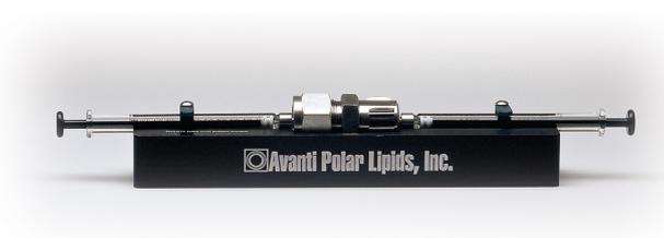
**Figure 2.6:** Photographie de l'extrudeur utilisé pour la préparation de LUV, acheté auprès d'Avanti Polar Lipids. La partie centrale du système contient une membrane poreuse. Une des seringue est remplie avec la suspension de MLV, et la suspension est poussée au travers de la membrane 21 fois. Les MLV se brisent au passage de la membrane en LUV. La photographie est extraite du site internet d'Avanti Polar Lipids [191].
