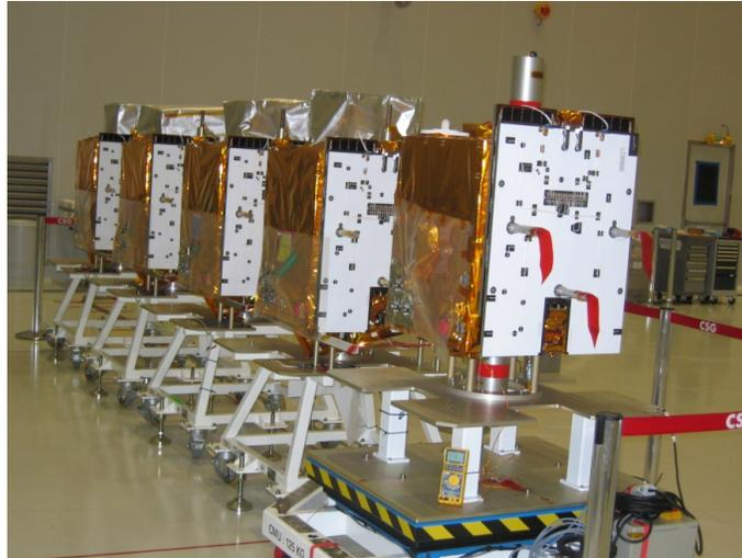
FIGURE 5.1: Plateformes MYRIADE en phase d'intégration pour différentes charges utiles (source CNES)
