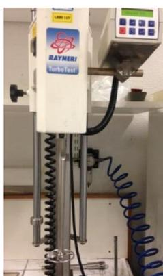
Figure 2-7 : Photographie du mélangeur de laboratoire Rayneri TurboTest.
