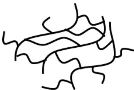
*Figure 1-33 : Représentation schématique d'un réseau de polymère réticulé.*
