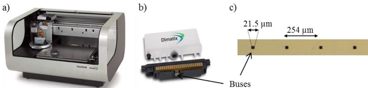
Figure 1: Photographies de (a) l'imprimante Dimatix CMP2831 de Fujifilm, (b) la cartouche et la tête jet d'encre et (c) quatre buses
