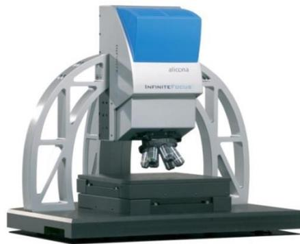
Figure II.6 : Photographie du microscope Alicona Infinite Focus
