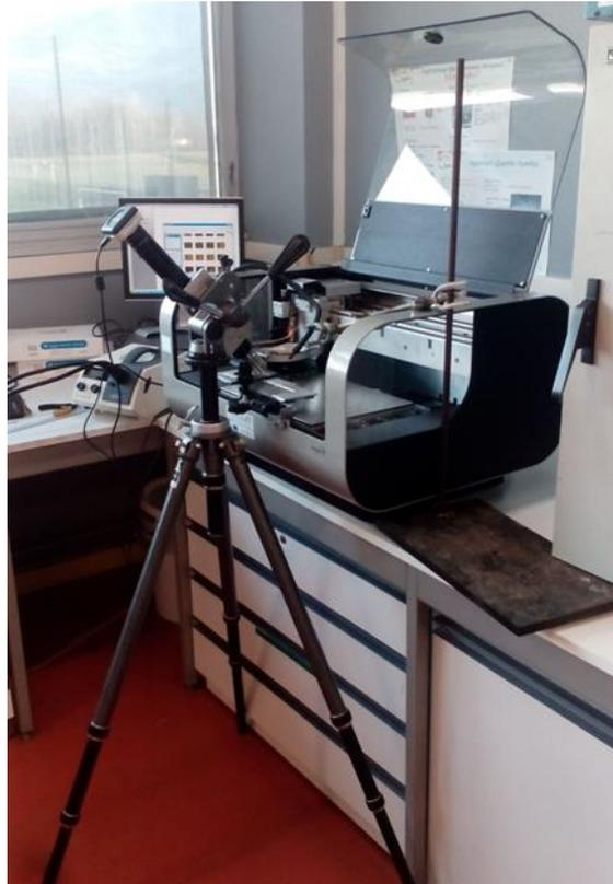
Figure II.15 : Photographie du système d'observation des gouttes après impression
