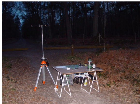
Figure 10 : Poste fixe de coordination des opérations de télémétrie, avec une antenne fixe 4 éléments, une carte de la zone d'étude, et tous les outils indispensables à la télémétrie (Photo L. Tillon).
