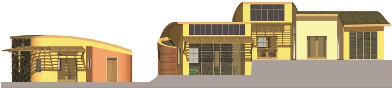
*Façade 1. Conception bioclimatique des façades du Hameau des buis conçues pour capter l'énergie solaire : grandes baies vitrées, brise-soleil, panneaux thermiques, finalement installés en toiture (© Pierre-Henry Gomez architecte)*
