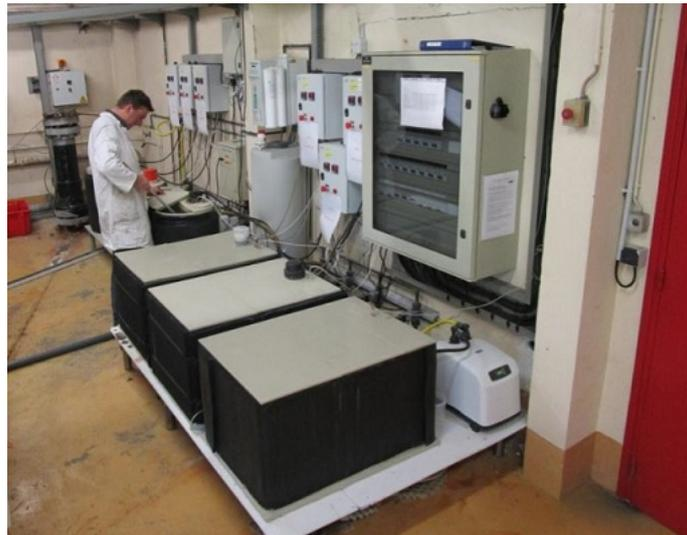
FIGURE II.19 – Bacs de vieillissement en immersion
