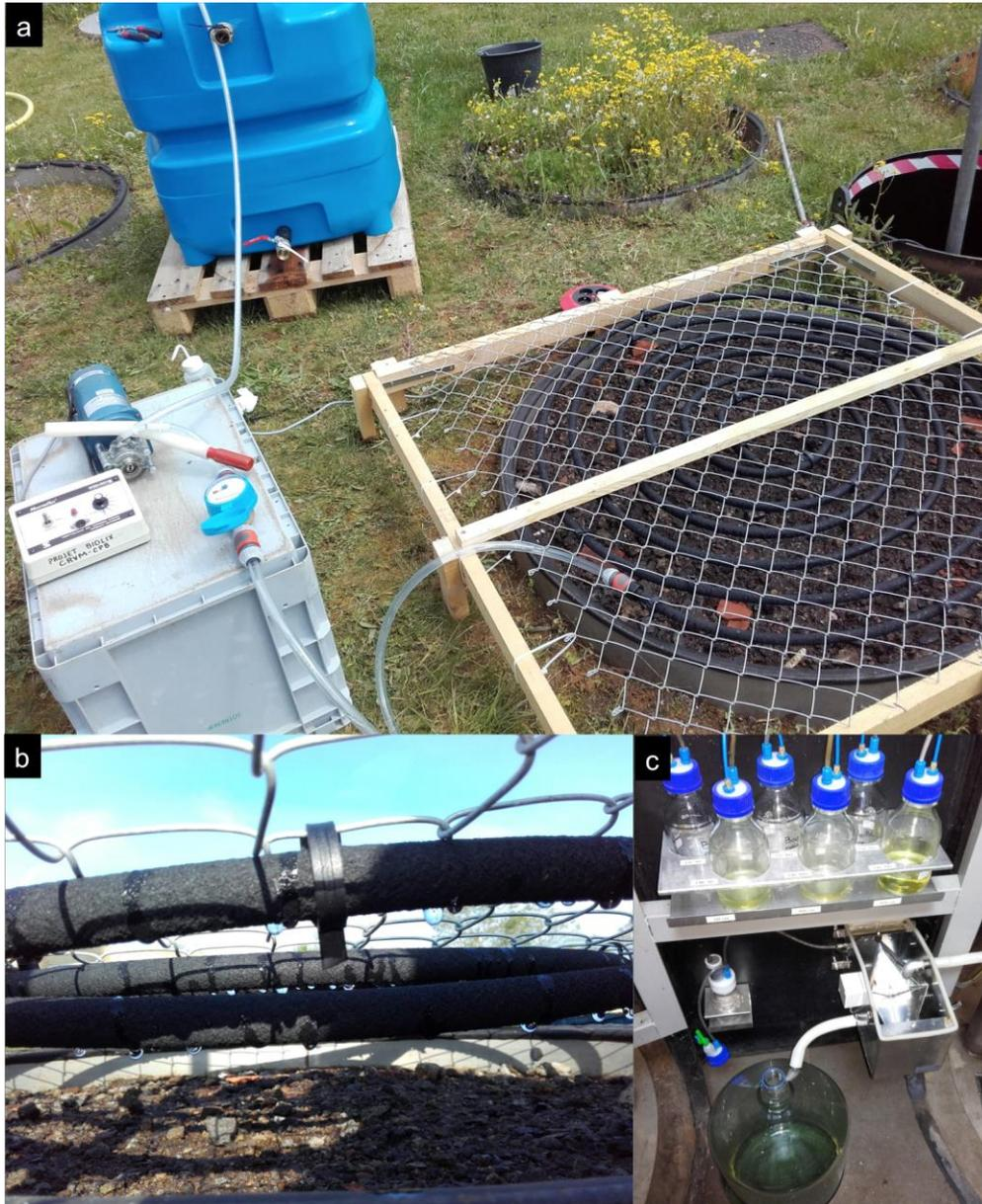
Figure 5- 7 : (a) Dispositif d'injection d'eau utilisé pour simuler des épisodes de pluie à l'aide (b) d'un tuyau microporeux (c) Prélèvement des percolats (bougies poreuses par dépression et percolat par gravité).
