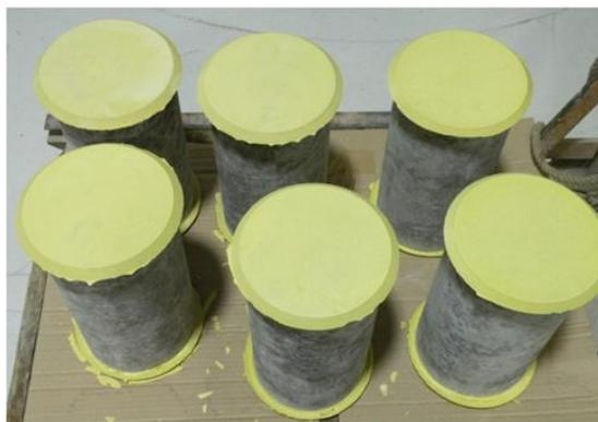
**Figure II-5. Surfaçage des éprouvettes au soufre**
