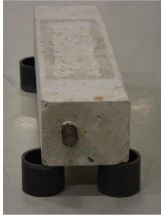
Figure VI-12. Vue des conditions d'appui du prisme lors de l'essai de corrosion accélérée
