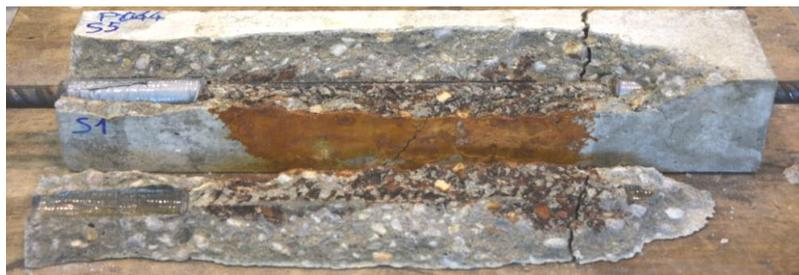
**Figure V-18. Ruine d'un corps d'éprouve (P064-28j-50) qui montre l'éclatement du béton d'enrobage**
