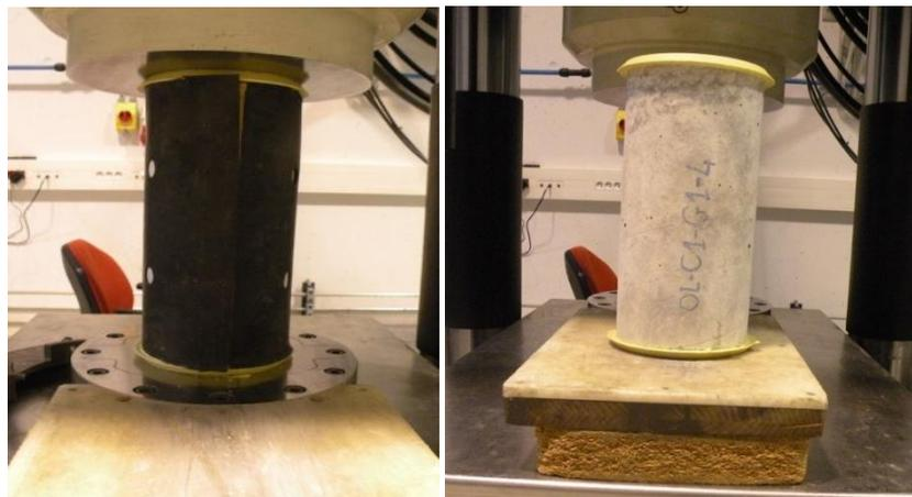
**Figure II-6. Test de compression**
