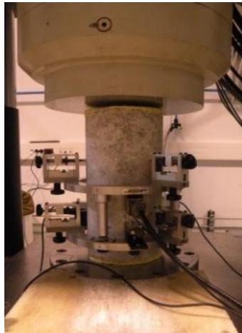
Figure II-8. Dispositifs permettant la mesure du module d'Young et du coefficient de Poisson
