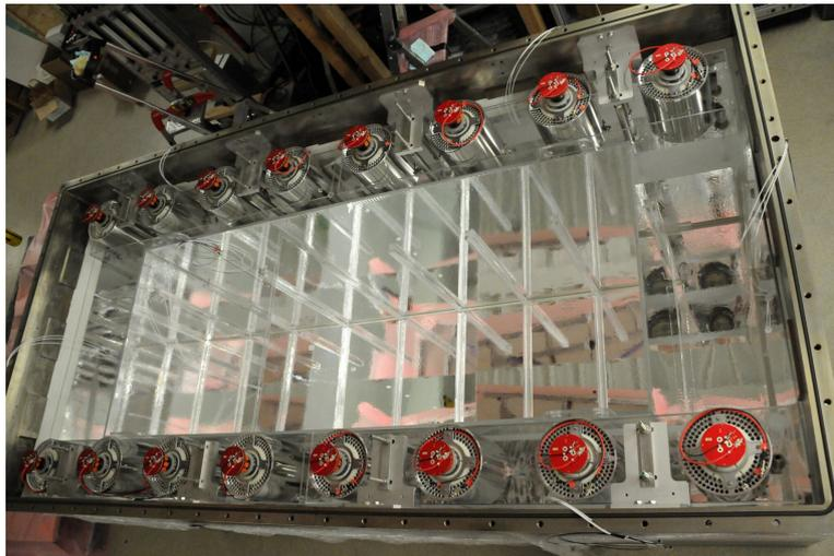
FIGURE 2.15 – Photo du détecteur interne dans sa cuve en acier prise lors de son montage au LPSC. Les 6 cellules de la cible sont visibles avec leurs parois réfléchissantes. Les PMT des longues cellules du *gamma-catcher* sont installés par 4 dans les *buffers*.
