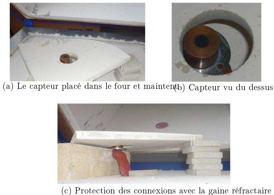
FIGURE 8.9 – Photos du montage de mesure de flux
