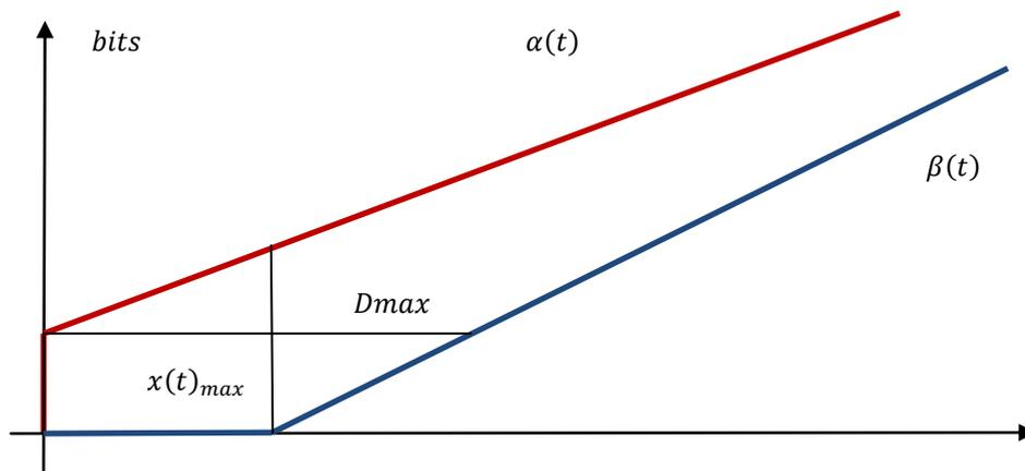
Figure 3.1. Majorant du délai  $D_{max}$  et de l'arrière de traitement  $x(t)_{max}$
