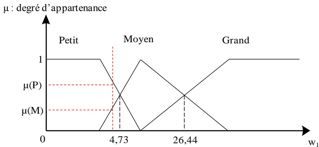
Figure 4.7. Fuzzification du poids  $w_1$  en 3 termes avec des courbes trapézoïdales-triangulaires
