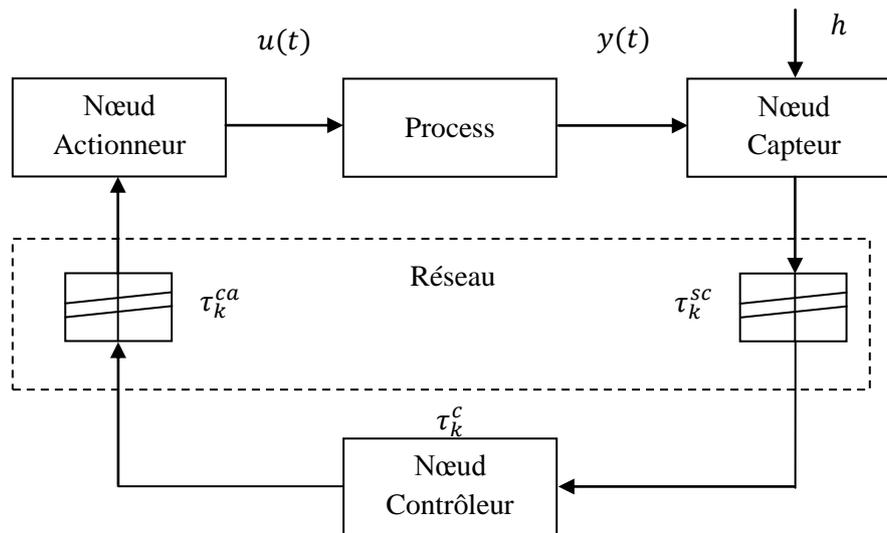
Figure 1.3. Système de commande numérique distribué avec des délais induits,  $\tau_k^{sc}$  et  $\tau_k^{ca}$ . Le délai de calcul dans le nœud du contrôleur,  $\tau_k^c$ , est aussi indiqué (Nilsson, 1998)
