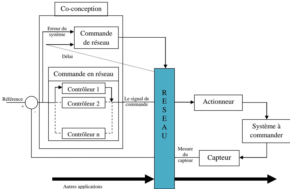
Figure 1.1. Réseau support d'un SCR et partagé avec d'autres types d'applications
