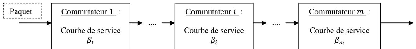
Figure 3.2. Cas d'un paquet traversant  $m$  commutateurs
