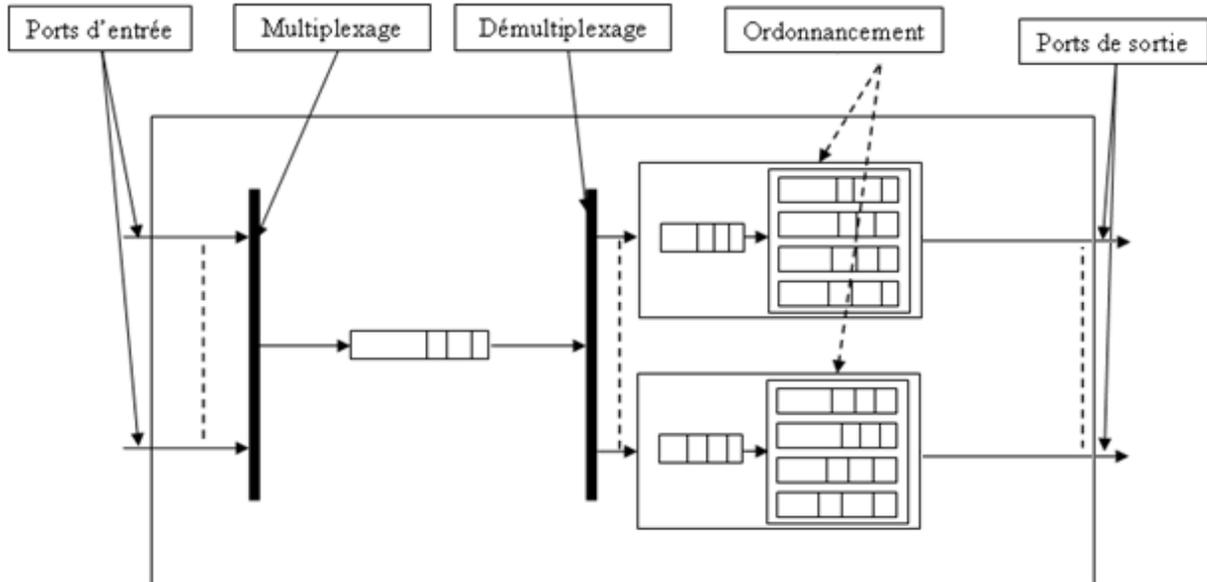
Figure 3.5. Modèle du commutateur incluant le protocole d'ordonnancement WRR
