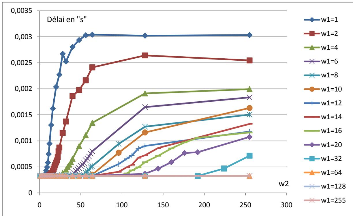
Figure 4.3. Délai en fonction de  $w_2$  à  $w_1$  constants et avec une charge moyenne de 5 Mb/s
