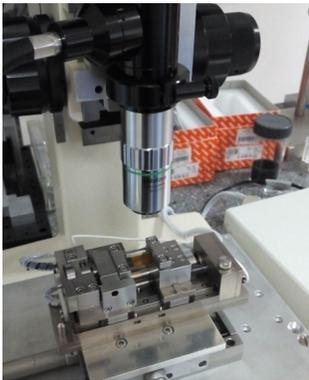
FIGURE 2.21 – Essai de traction sous microscope optique.
