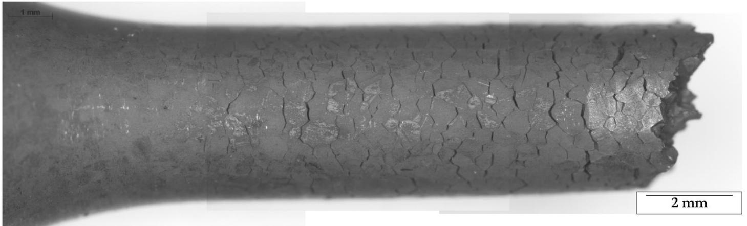
Figure III-26 : Observation à la loupe binoculaire du fût de l'éprouvette GG testée en fluage à 850°C / 250 MPa
