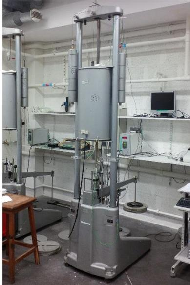
**Figure II-9 : Machine de fluage sous air Adamel**
