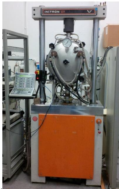
**Figure II-12 : Machine hydraulique avec enceinte sous vide secondaire Instron 1271**
