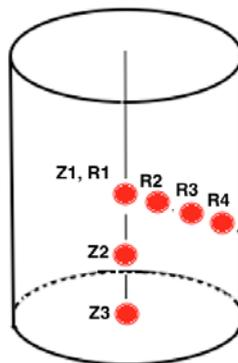
FIGURE IV .7: Schéma représentant les six localisations spatiales de la source de  $^{239}\text{Pu}$  au sein du fût de déchets
