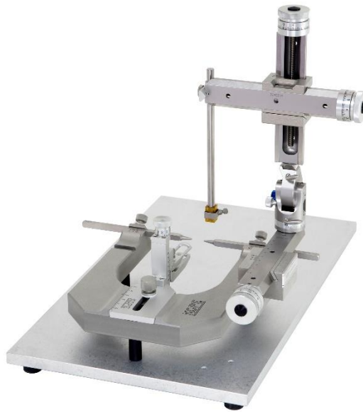
Figure 31: Un cadre stéréotaxique pour rongeurs. Source : Phymep
