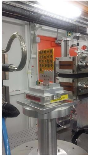
Figure 120 : Photo du passeur d'échantillons ex-situ
