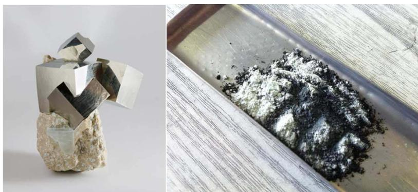
Figure 67 : Echantillon de FeS<sub>2</sub> avant fluoration (à gauche) et après fluoration (à droite)
