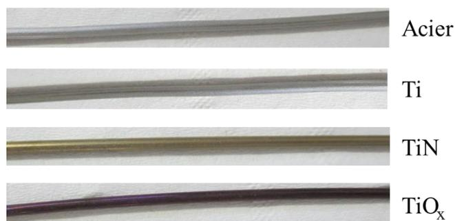
*Figure 4-21 : photographies de fil non revêtu et revêtus de Ti, de TiN et de TiO<sub>x</sub> après 1500 heures d'essai au le brouillard salin.*
