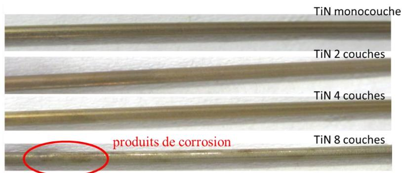
Figure 5-9 : photographies des revêtements TiN 1, 2, 4 après 1500 heures dans le brouillard salin et TiN 8 couches après 24h. Des produits de corrosion sont visibles dans la zone encadrée en rouge. (Conditions d'élaboration : cathode : Ugi 1 ; dépôts dynamique TiN ;  $P_{travail} = 900 \text{ W}$  ;  $P_{Ar} = 5 \text{ mTorr}$  ;  $\phi_{N_2} = 1,2 \text{ sccm}$  ;  $V_a = 30 \text{ V}$ )
