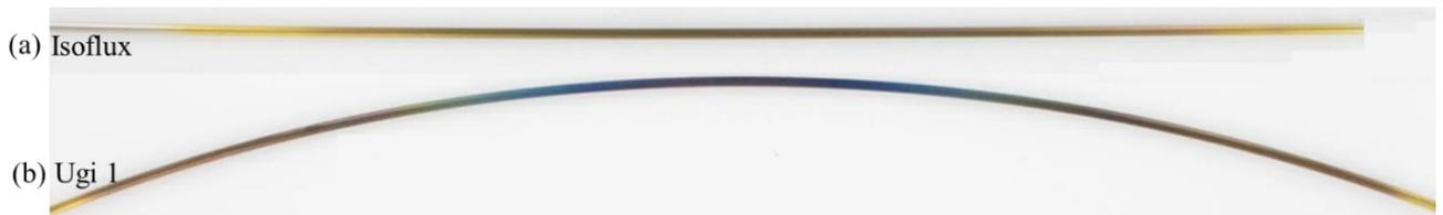
Figure 3-11 : photographie de deux dépôts statiques de nitrure de titane élaborés (a) avec Isoflux et (b) avec Ugi 1.
