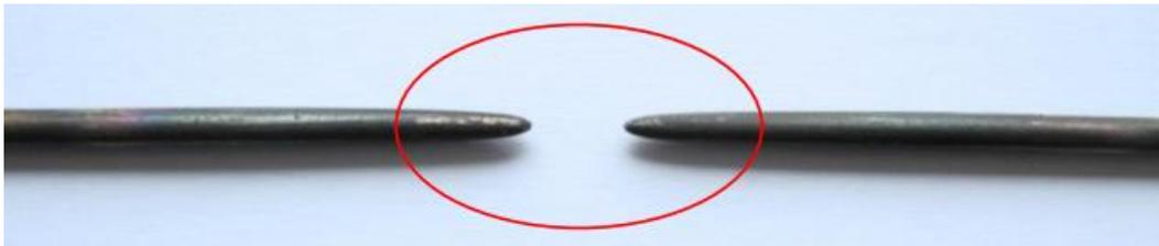
Figure 1-8 : Photographie de la rupture d'un échantillon dans la chambre de dépôt par fluage, causée par l'énergie thermique stockée dans le fil [5].
