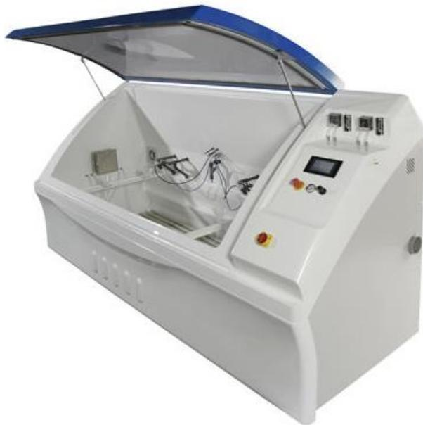
Figure 2-19 : Exemple d'enceinte de test du brouillard salin.
