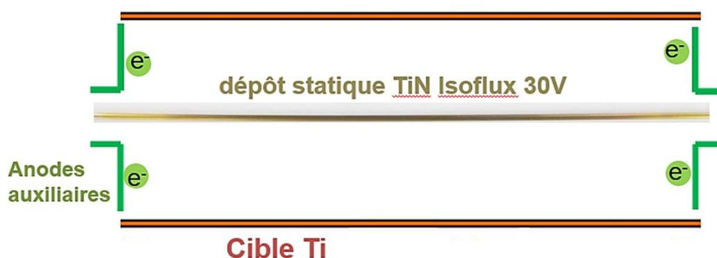
Figure 3-16 : photographie d'un dépôt statique TiN Isoflux avec une polarisation d'anode de 30 V. Le schéma à l'échelle de la cathode met en évidence la position des anodes par rapport au fil.
