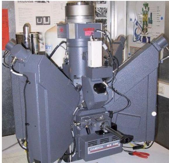
Figure 2-11 : photographie d'une microsonde CAMECA, équipée de quatre spectromètres.
