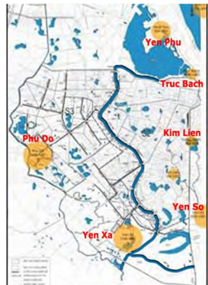
Figure V.31: Schéma qui fait de la rivière Tô Lịch un égout de drainage énorme - Position : 7 stations de traitement des eaux usées (en jaune sur le schéma), inutiles, malgré le coût de leur construction, qui s’élève à un milliard de dollars 2 .
