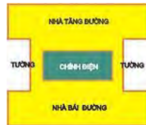
Plan de pagode en caractère de Tam (三) La pagode a trois couches de maison parallèles
