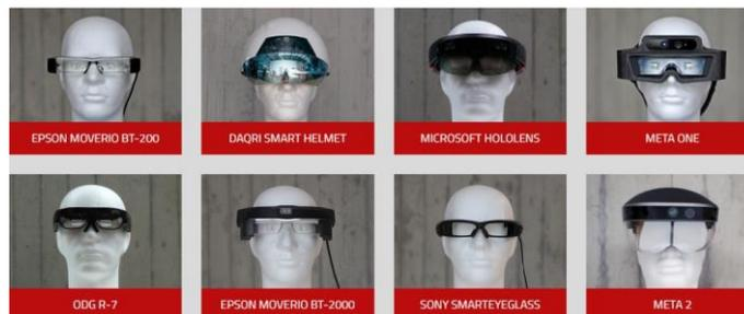
Figure 18 : lunettes et casques binoculaires de réalité augmentée (source UBIMAX <http://www.ubimax.com/en/portfolio/#hardware>)
