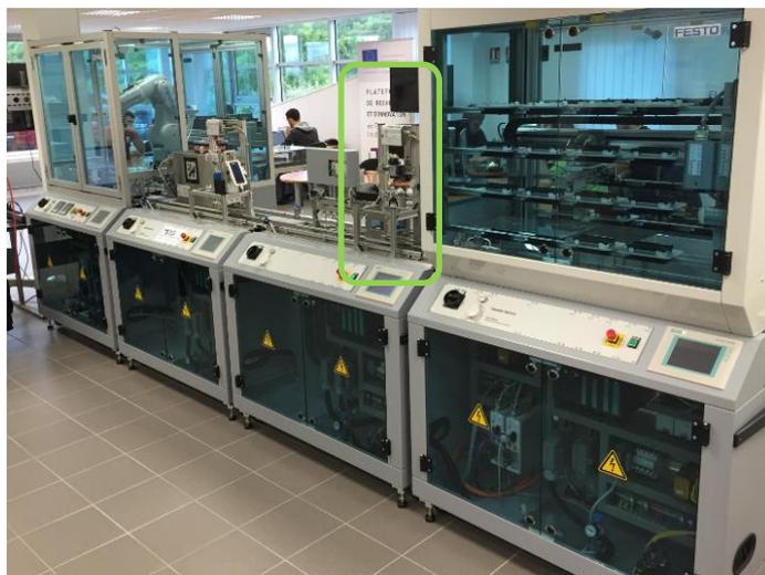
Figure 53: chaîne de production didactique sur laquelle l'opération de maintenance est effectuée. Le module de presse est encadré en vert.
