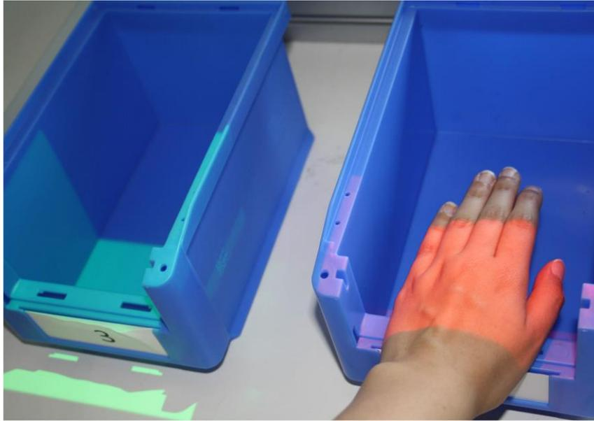
Figure 28: retour visuel permettant d'indiquer à l'opérateur dans quelle boîte prendre le composant. En vert, la boîte dans laquelle prendre le composant. En rouge, l'opérateur place la main dans la mauvaise boîte. La projection rouge montre que l'opérateur a fait une erreur. Extrait de (Funk, et al., 2016).
