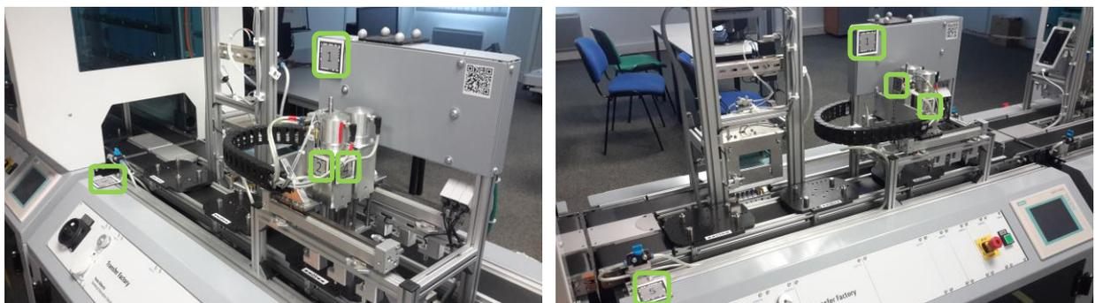
Figure 71: marqueurs placés sur le système pour permettre le suivi en réalité augmentée (encadré en vert). A gauche, les marqueurs 1, 2, 4 et 5 sont visibles, à droite les marqueurs 1, 2, 3, 5 sont visibles.
