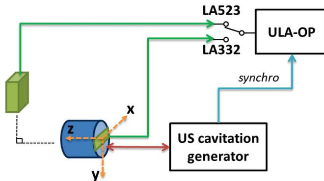
**Figure 21 : Configuration générale utilisant à la fois le système thérapeutique (générateur de cavitation ultrasonore régulé) et le système d'imagerie avec un échographe ULA-OP couplé à deux sondes d'imagerie (LA523, LA332) synchronisées avec l'insonification thérapeutique ultrasonore.**
