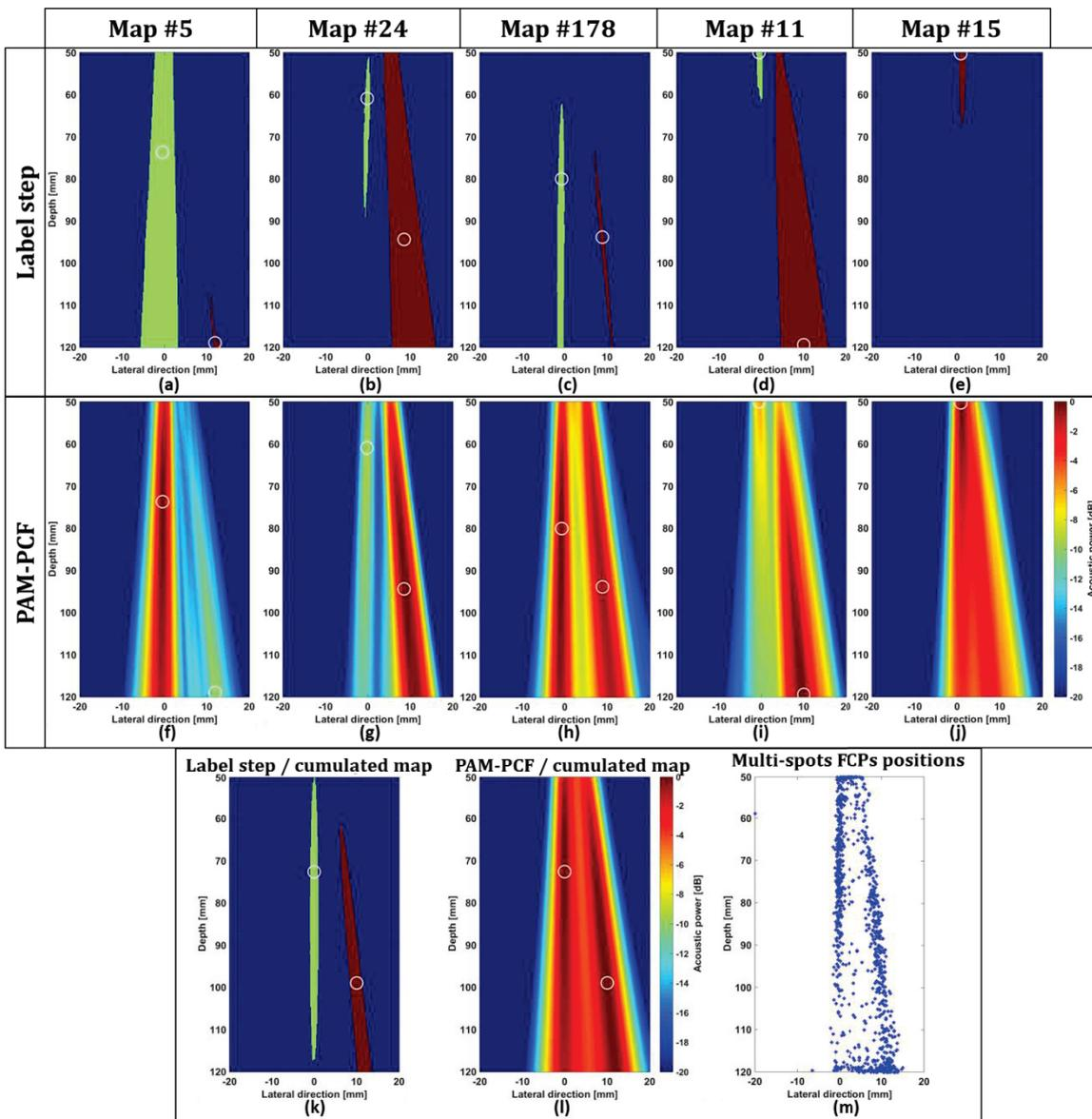
Figure 31 : Les deux  $out_1$  et  $out_2$  sont activés (les deux nuages de bulles  $bc_1$  et  $bc_2$  étaient générés). (a-e) L'étape de localisation multi-tâches focales avec l'application d'un seuillage puis de l'étape de segmentation par classe sur 5 cartographies de cavitation reconstruites préalablement par PAM-PCF. (f-j) Les 5 cartographies de cavitation correspondantes avec la localisation des FCP multipoints pour les deux spots de cavitation. Le cercle blanc correspond à
