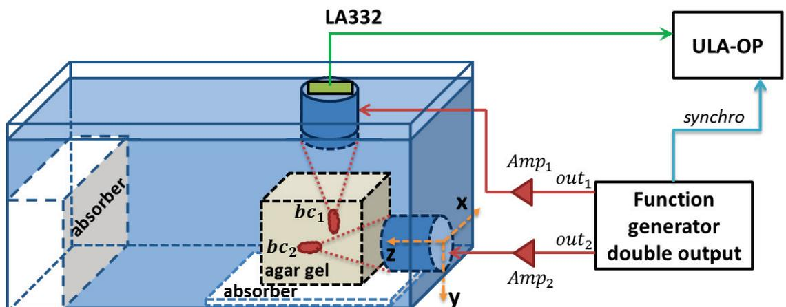
Figure 30 : Expérience de cavitation utilisant deux transducteurs thérapeutiques pour générer deux nuages de bulles différents et indépendants ( $bc_1$  et  $bc_2$ ). Le système d'imagerie avec la sonde (LA332) est synchronisé avec les deux impulsions d'insonification ultrasonore.
