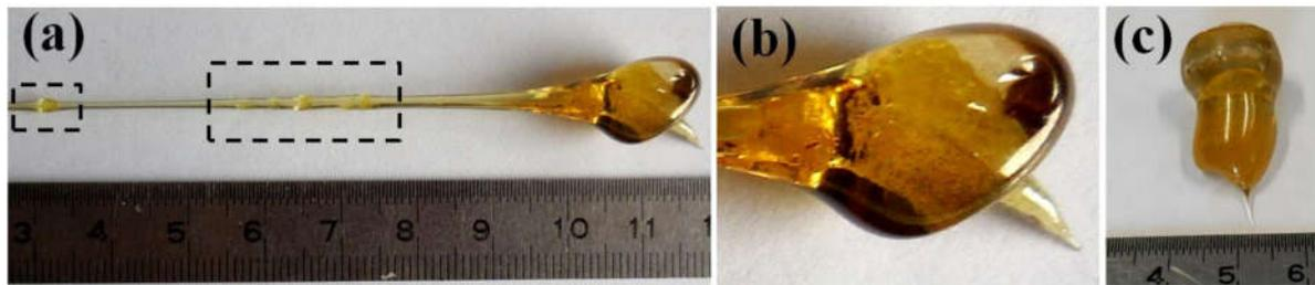
Figure V.12 : Photos (a) et (b) d'une goutte de fibrage et (c) du cône de fibrage d'une préforme double-indice en GPN-TWNb fabriquée par BiC, après étirage.
