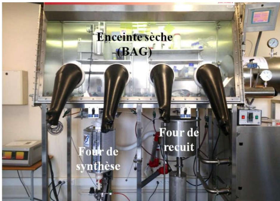
Figure III.11 : Photo du dispositif utilisé pour la synthèse de verre de tellurite en BAG.
