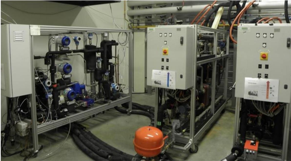
Fig.2. 2. Prototype de machine à absorption connecté au banc d'essai
