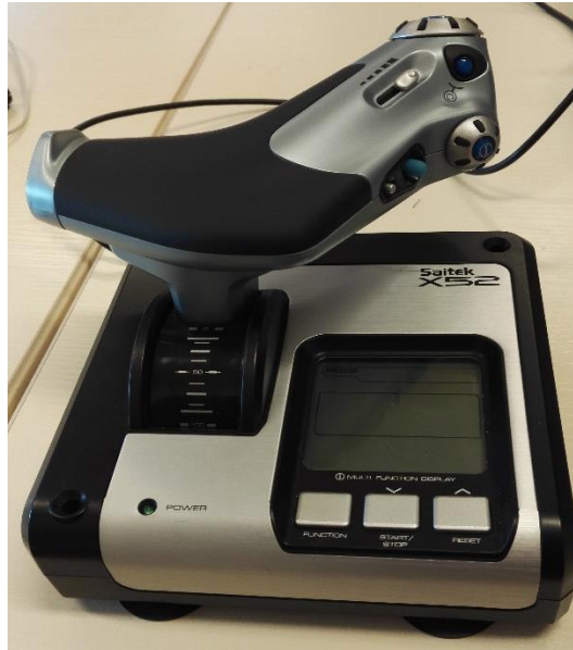
Figure 3.2 – Joystick Pro Flight X52 de Saitek® utilisé dans les tâches de régulation d'approche au sol.
