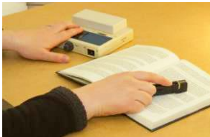
Figure 1.12 – L'Optacon, dispositif de substitution sensorielle, permettant de convertir en stimuli vibrotactiles tout support écrit.
