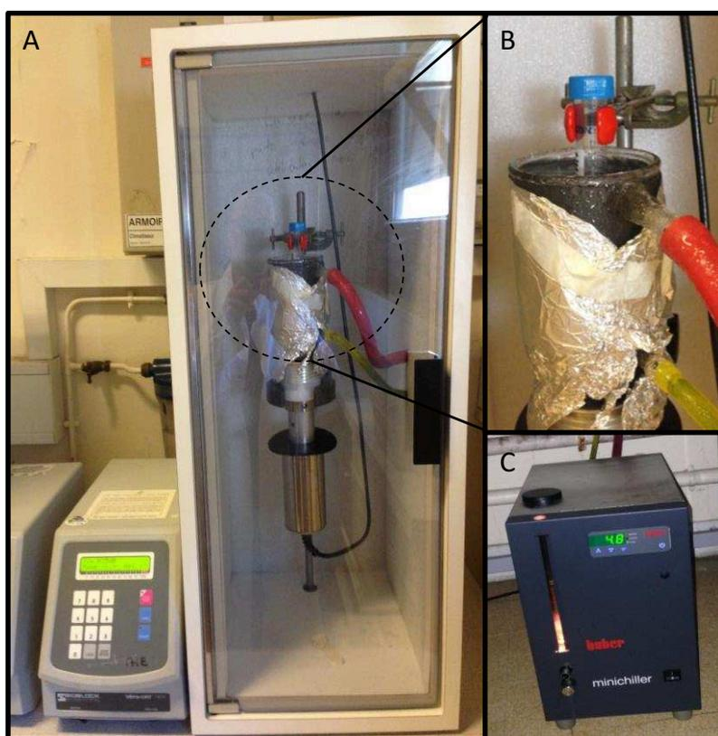
Figure 34 : Montage du Cup-Horn. Photographies de la dispersion d'une suspension de particules avec un sonificateur de type Cup-Horn. A) Générateur et enceinte contenant le montage du Cup-Horn. La sonde et l'échantillon (B) sont dans un bain d'eau à 4-5°C, refroidit par le dispositif de refroidissement (C).
