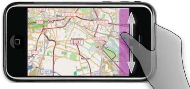
**Figure 3.13 - Navigation par inclinaison du dispositif: la vitesse de navigation est calculée par rapport à l'angle d'inclinaison et le niveau de zoom est contrôlé à l'écran par l'interaction tactile. Issue de [72].**
